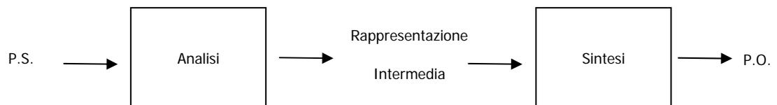
Nel modello analisi-sintesi il compilatore viene visto come la composizione di due moduli (funzioni): il modulo dell'analisi e il modulo della sintesi.
