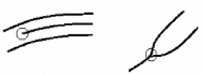
Figura 2.10 Esempi di ridge endings e ridge bifurcation [52]
